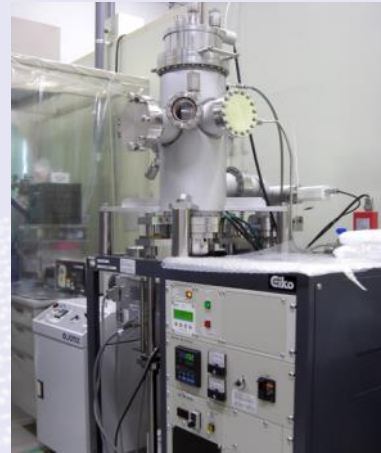
電子線(EB)リソグラフィー装置 ナノ構造の微細加工
