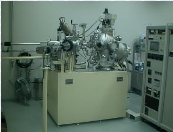
分子線エピタキシー装置 GaAs系半導体超薄膜の結晶成長
