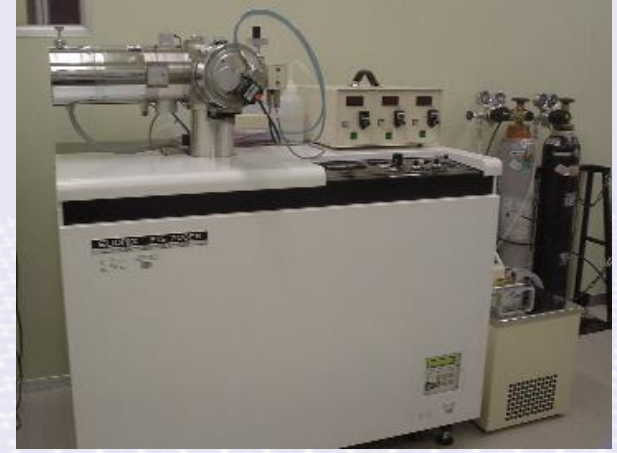
イオンビームエッチング装置 ナノ構造の微細加工
