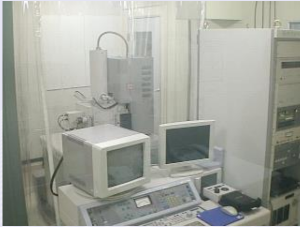
電子線(EB)リソグラフィー装置 ナノ構造の微細加工
